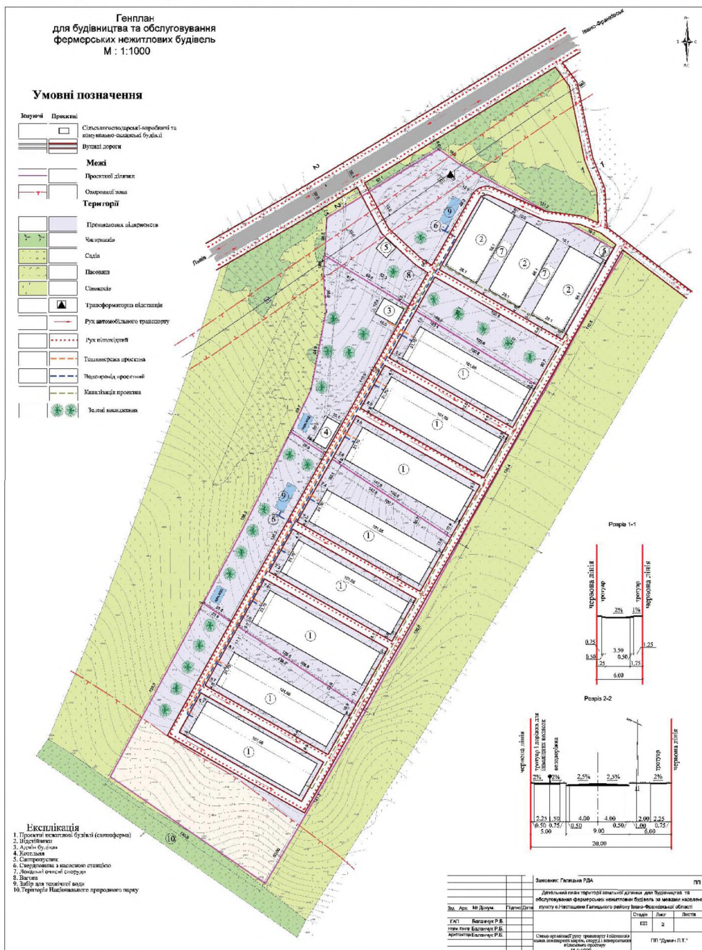
Рисунок 4.3. – Схема організації руху транспорту і пішоходів, схема інженерних мереж, споруд і використання підземного простору
